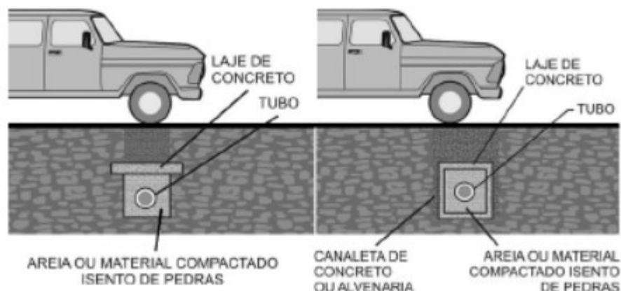
Figura 2 - Lajes e canaletas para proteção de tubulação.
